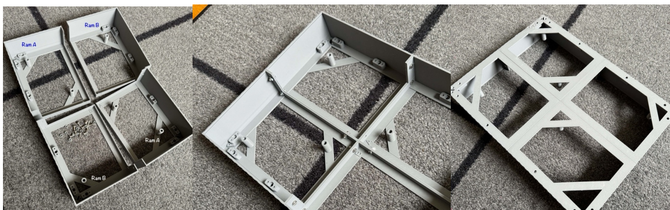
Till vänster syns de 2 typerna Ram A och Ram B. I mitten är dessa hopskruvade med M4 skruv och mutter. Högra bilden visar en hel ram storlek 300 x 400 mm
