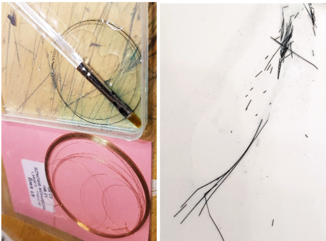
Vänster: Enminuters oxidering av tråd. Höger: entimmars ... hoppsan!
