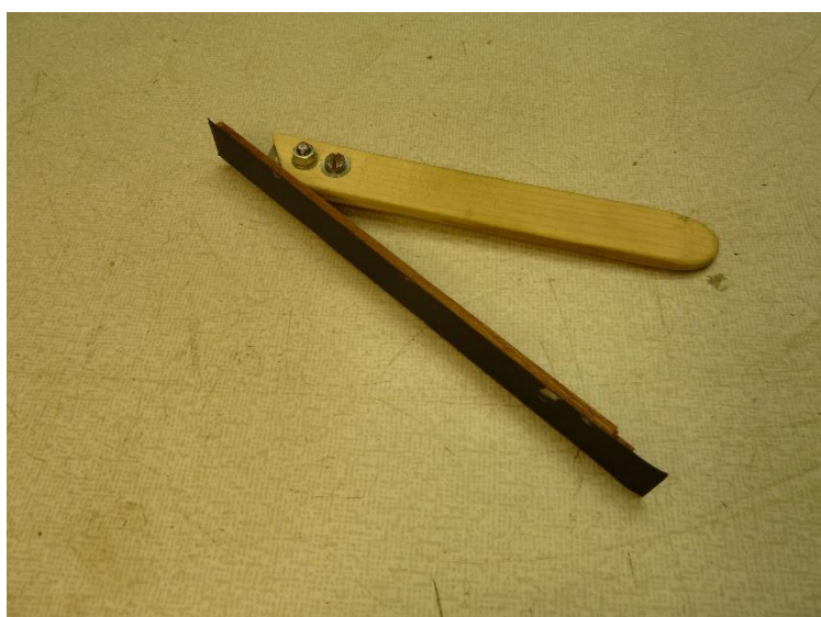
Fastsättning av kartong /plasticard på ena sidan och hur respektive plankor skärs separat
